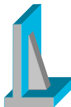
控え壁式擁壁
