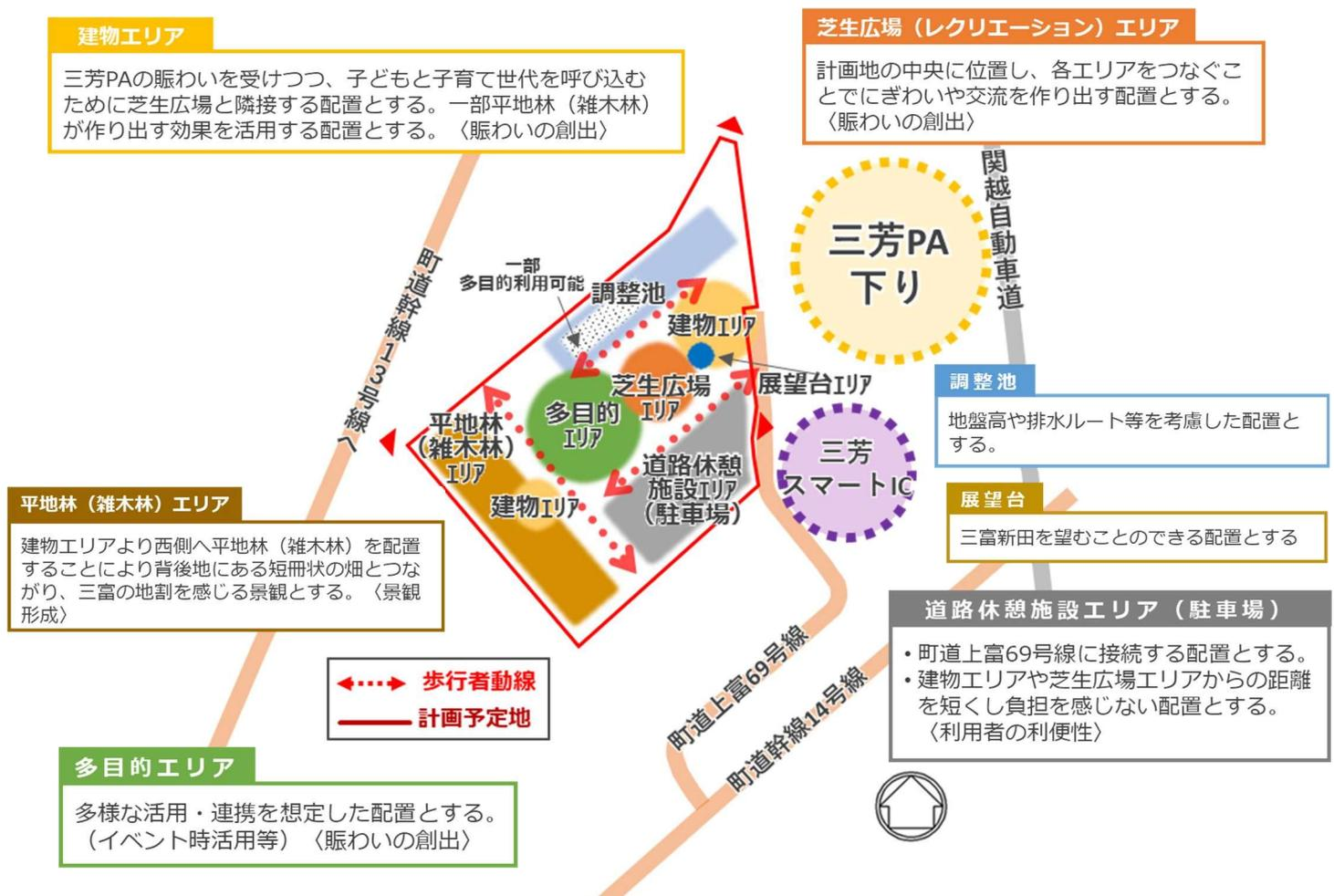
図 5-2 ゾーニング図および施設配置の考え方
