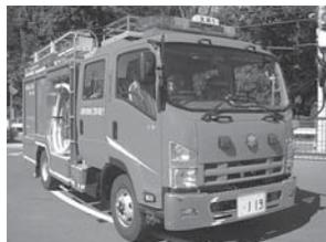
従来型よりも収納スペースを大きくとり、小回りがきく設計になっています。水槽には1,500リットルの消火用水を積載しています。
