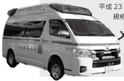
平成23年に導入した西消防署の高規格救急自動車を、老朽化に伴い最新鋭の車両に更新しました。ベッドには空気式の防振架台を使用し、より安定した状態で傷病者の搬送を行うことができます。
