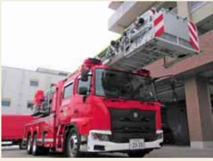
3月27日、西消防署に配備する38 m級はしご付消防自動車を20年ぶりに更新しました。この車両は、はしご先端のバスケットに自動放水銃を搭載し、高所から無人放水活動を行うことができます。地上の機関員(隊員)がバスケットに取り付けられたカメラの映像を見て、放水角度や放水量を基部操作で調整することができるため、長時間にわたる大規模な火災の際に効果的な無人放水活動ができるようになりました。また、伸縮旋回機能などの基本性能が向上したことで、以前の車両より安全性と迅速性が格段に向上しました。これからも皆さんの暮らしの安全・安心を確保してまいります。
