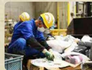
作業員が手で選別します。ごみの種類で分けたり、家電を解体して、細かく分別しています。
