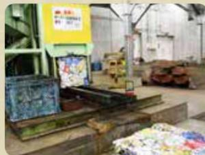
飲み物のかんは磁石の力でアルミとスチールに分け、約150缶ずつ板状に押し固められます。
